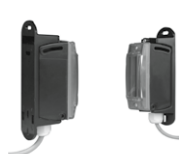
D – Vorrichtungen zum Erfassen der Anwesenheit einer Person oder eines Hindernisses am Boden auf einer Torseite, z.B. Lichtschranken. Anmerkung! Wird eine Kombination aus C + D verwendet, muss die Vorrichtung D regelmäßig in Abständen von nicht mehr als 6 Monaten überprüft werden.
